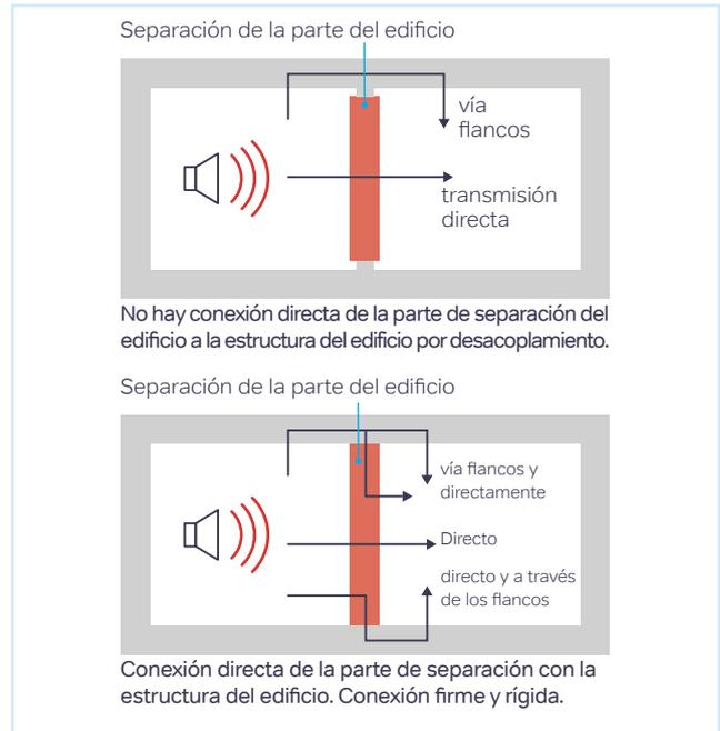
Figura 7: Información sobre las posibles rutas de transmisión para diferentes elementos de la construcción
