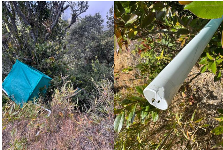
Figura 38. Fotografías de la visita del 8 de noviembre de 2025 - daños al captador cúbico.
