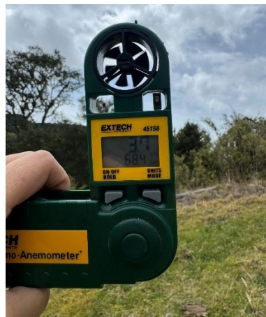
Figura 30. Ejemplo de medición de velocidad de viento in situ con anemómetro.
