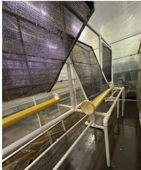
Figura 15. Sistema de captación de neblina con inclinaciones de 90°, 70° y 45°.
