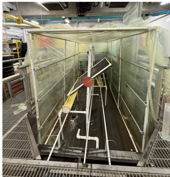
Figura 2. Sistema de nebulización que reproduce la neblina con paneles inclinados.
