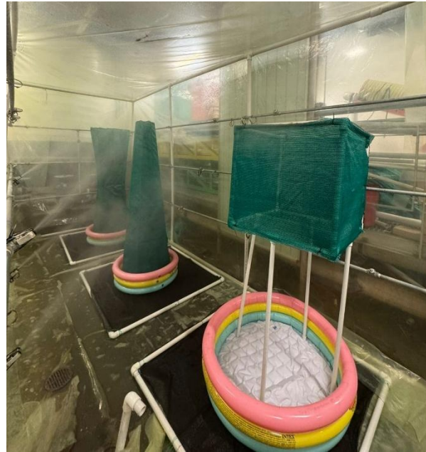
Figura 3. Sistema de nebulización que reproduce la neblina con captadores de diferentes geometrías.
