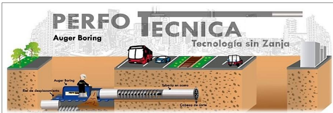
Figura 4 Esquema general de aplicación del método Auger Boring. Fuente: (PERFOTÉCNICA, 2023)
