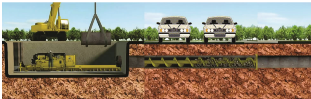
Ilustración 13. Esquema de proceso de perforación con tornillos Sin-fin. Tomado de: Perforaciones e Ingeniería. (2015).
