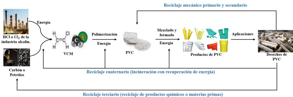
Ilustración 1. Esquema general del proceso de producción de PVC y cuatro tipos de reciclaje de desechos de PVC expuestos de manera general (L. Lu et al., 2023).
