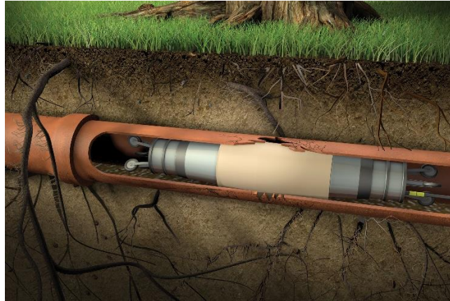
Figura 27. Técnica reparación puntual
