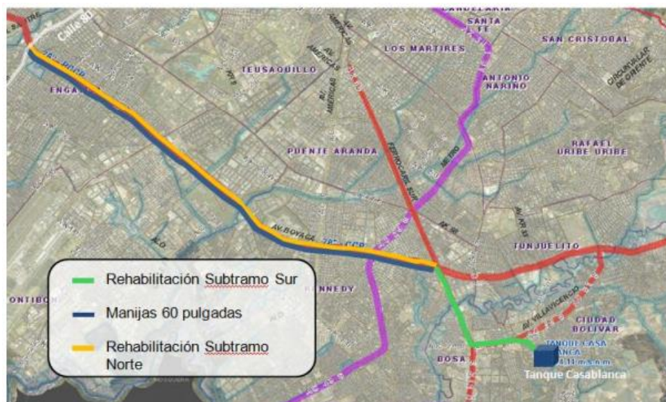
Figura 63. Etapas de la rehabilitación del Tramo 3 de la línea Tibitoc-Casablanca.
