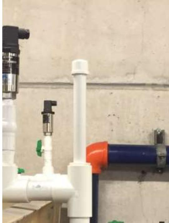
*Figura 15: Amortiguador de tubería PVC 15 cm.*
