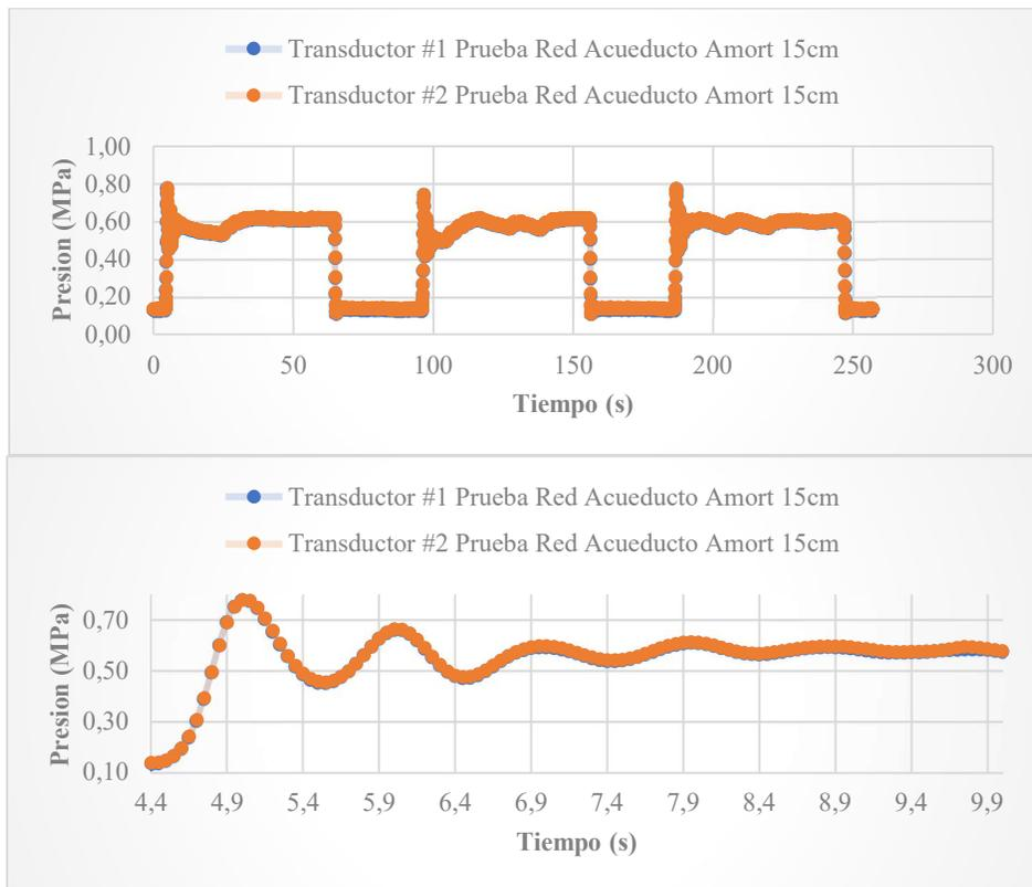
Figura 51: Golpe de Ariete a 0,13 Mpa en Modelo tubería 1/2" – Amortiguador Tub 15 cm Long–
