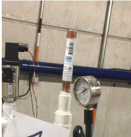
*Figura 17: Amortiguador Zurn Tipo Pistón 1/2"*
