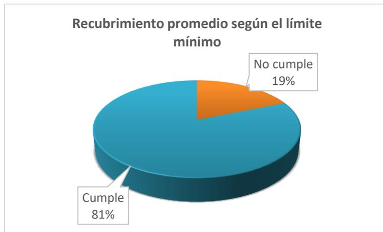
Gráfica 59. Recubrimiento de excavación promedio de diseño inicial según el límite mínimo. Red Apulo
