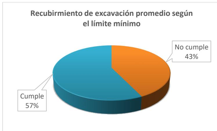
Gráfica 3. Recubrimiento de excavación promedio diseño inicial según el límite mínimo. Red San Luis
