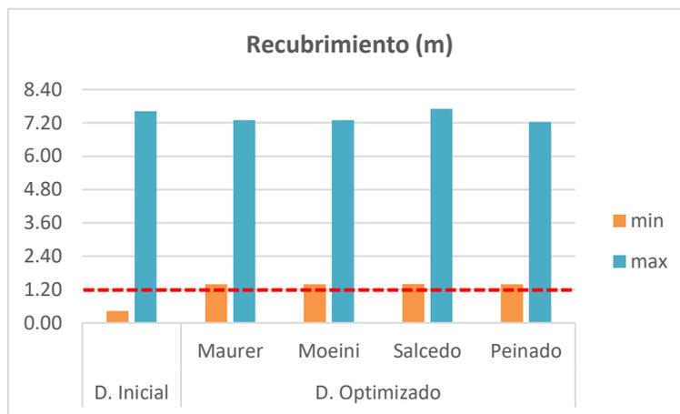
Gráfica 176. Valores del recubrimiento de la red La Junta
