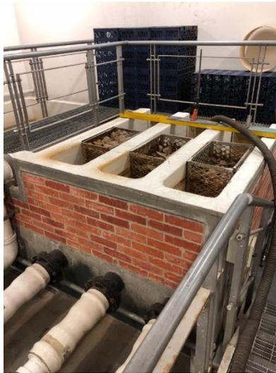
Ilustración 53. Vertederos laboratorio de alcantarillado Uniandes
