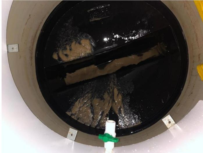
**Ilustración 58. Cañuela desarenador helicoidal pos ensayo**
