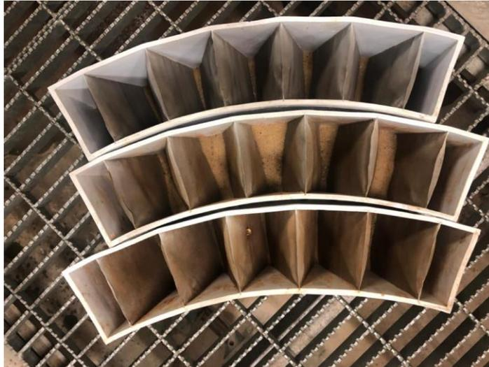
Ilustración 60. Filtros del desarenador pos ensayo
