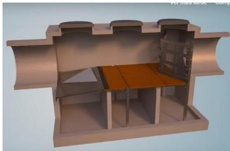
Ilustración 19. Pantalla de secado, Hydro Dry Screen
