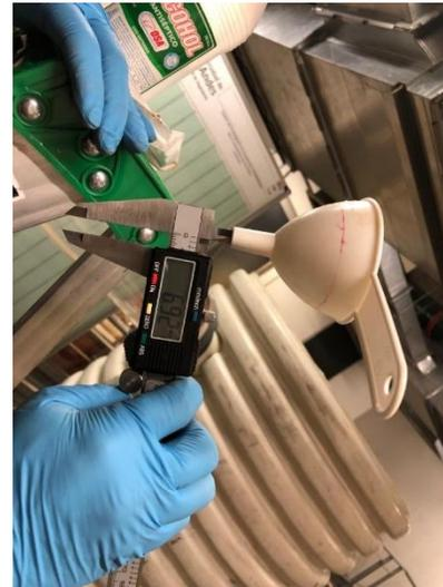
Ilustración 55. Diámetro interno del embudo
