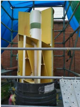
Ilustración 49. Composición interna del desarenador helicoidal
