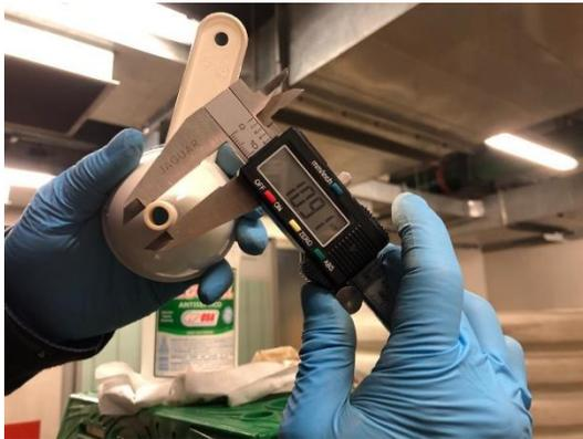
Ilustración 54. Diámetro externo del embudo
