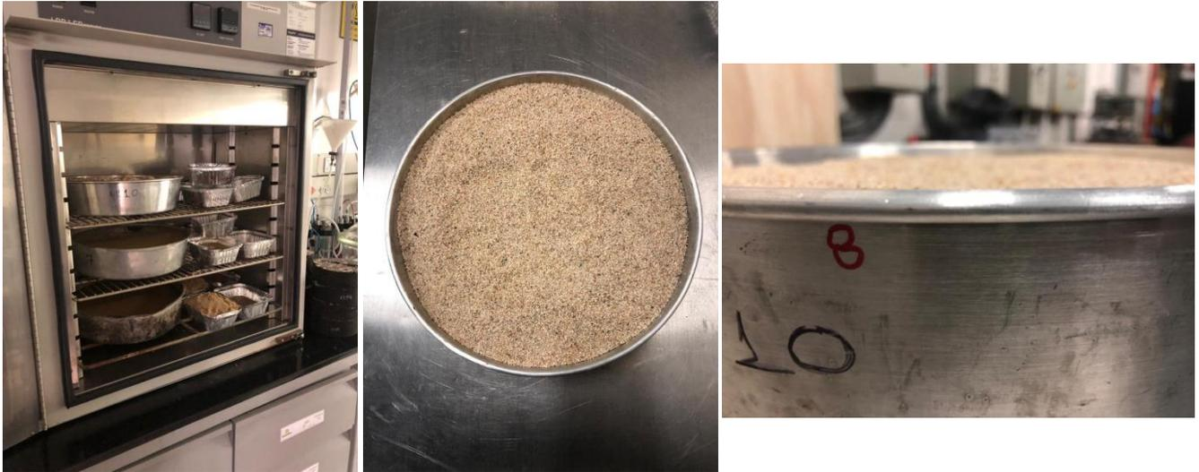
Ilustración 65. Secado de las arenas en horno
