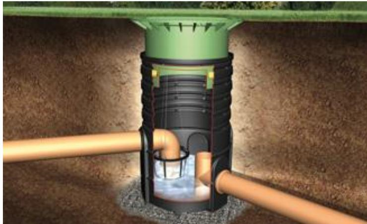
**Ilustración 10. Filtro de sedimentación**
