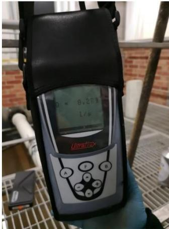
Ilustración 51. Caudalímetro Ultrasónico
