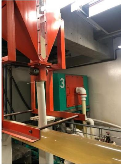
Ilustración 57. Embudo instalado a la salida de la tolva
