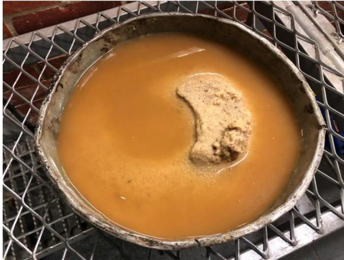
Ilustración 62. Muestra de arenas retenidas en el desarenador
