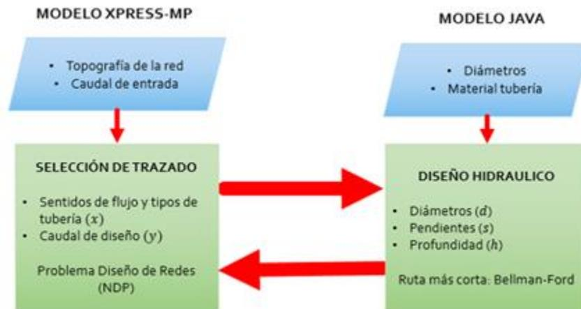
Figura 4. Esquema del funcionamiento del programa UTOPIA (Aguilar, 2016).
