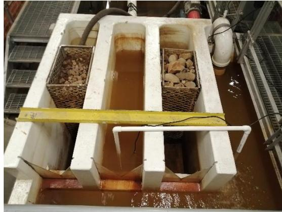
**Ilustración 9. Vertedero de salida**
