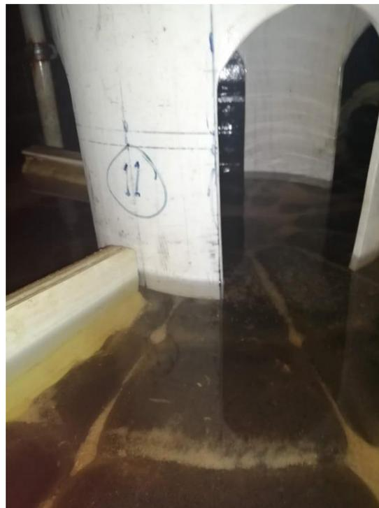
**Ilustración 26. Interior de la cámara desarenadora luego de remover la arena de las pruebas anteriores**
