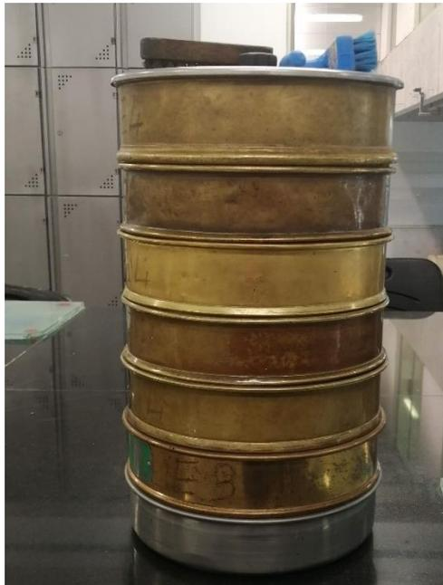
**Ilustración 14. Tamices con los que se realizó la granulometría de las muestras de arena saliente de la cámara**
