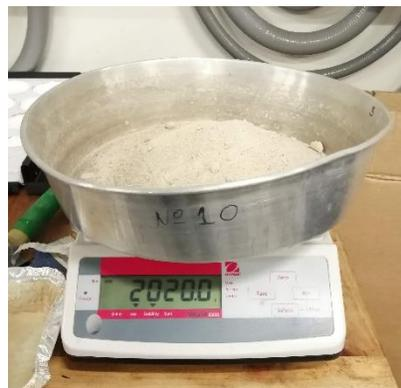
Ilustración 13. Arena en la balanza luego de secarla en el horno
