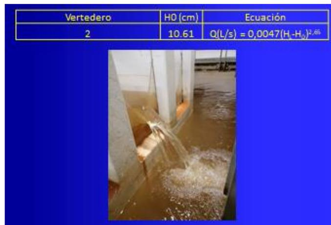
**Ilustración 6. Curva de calibración del vertedero de salida**
