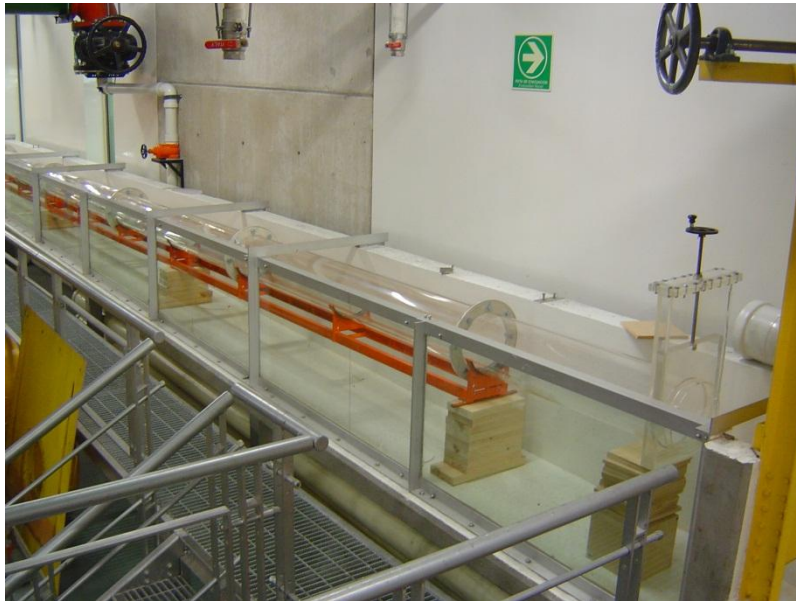
Ilustración 43. Vista de la compuerta en el montaje.
