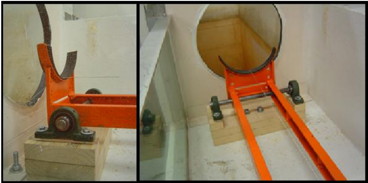
Ilustración 36. Fijación del soporte por medio de las chumaceras.
