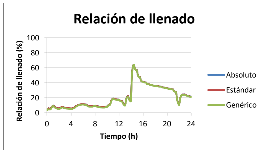
Gráfica 58 Relación de llenado en la Tubería T180. Comparación de Métodos (Detalle 1).
