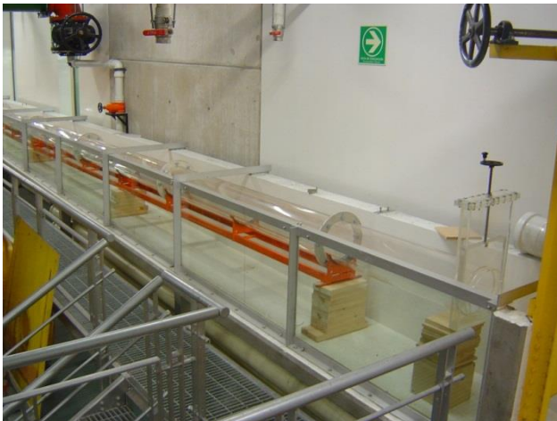
Ilustración 15. Vista de la compuerta en el montaje.
