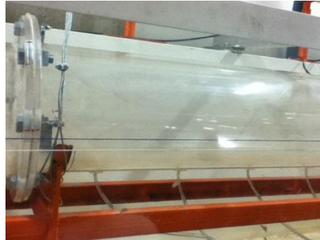
Ilustración 21. Piezómetros en la tubería.
