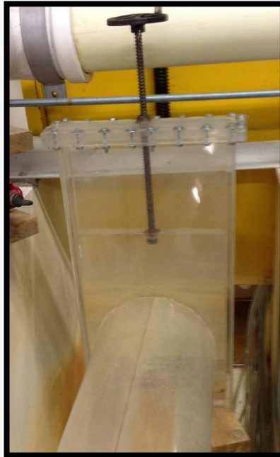
Gráfica 46. Compuerta aguas abajo de la tubería para controlar el fenómeno del resalto hidráulico.
