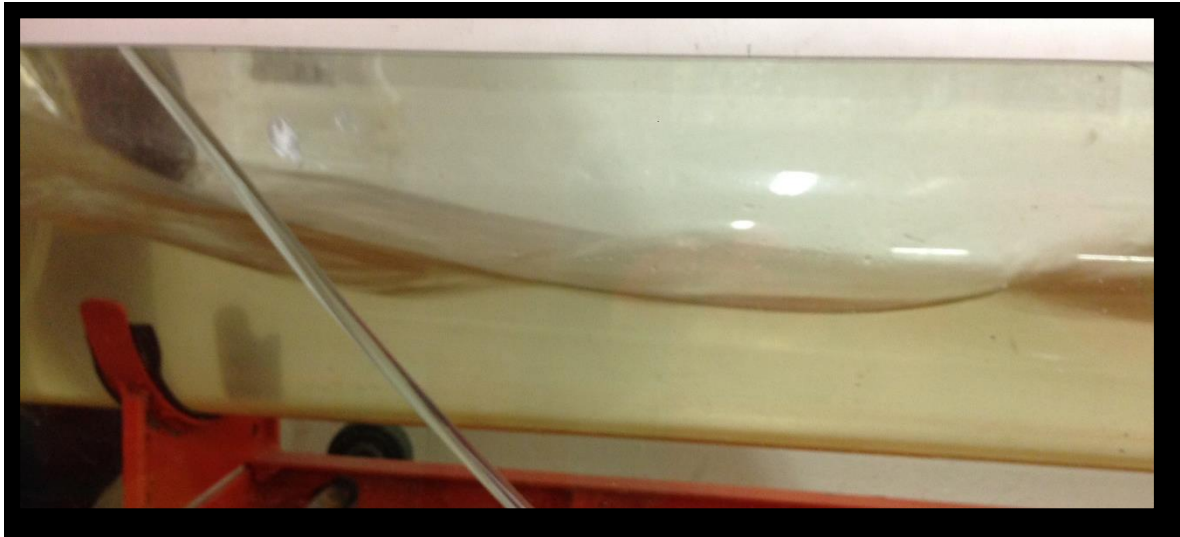
Gráfica 45. Ensayo de prueba aguas arriba para la verificación de los instrumentos y la tubería.
