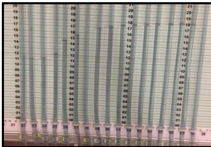
Gráfica 49. Alturas piezométricas del resalto hidráulico.
