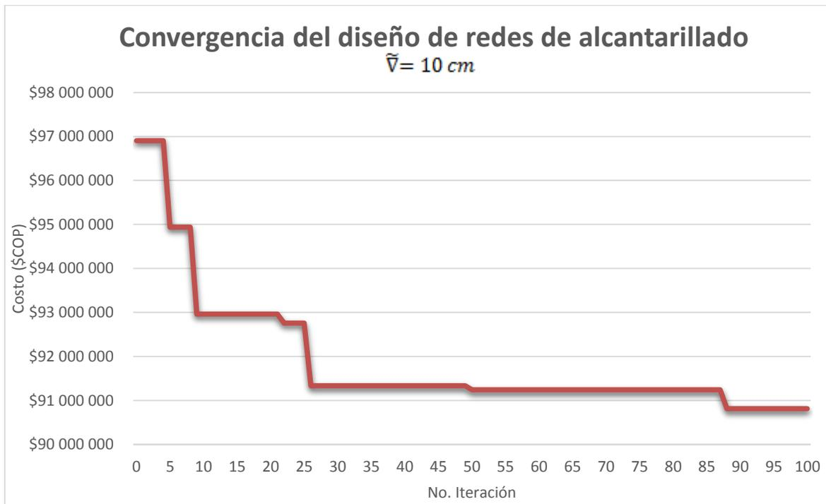
Gráfica 5.2. Convergencia al mejor trazado de la red de alcantarillado ( $\bar{V} = 10 \text{ cm}$ ).
