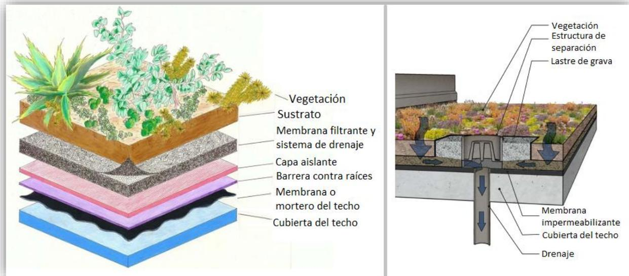
**Figura 5. Sección transversal típica y estructura de drenaje del techo verde (adaptado de Urban Drainage and Flood Control District, 2010 y Clean Water Services, 2009).**
