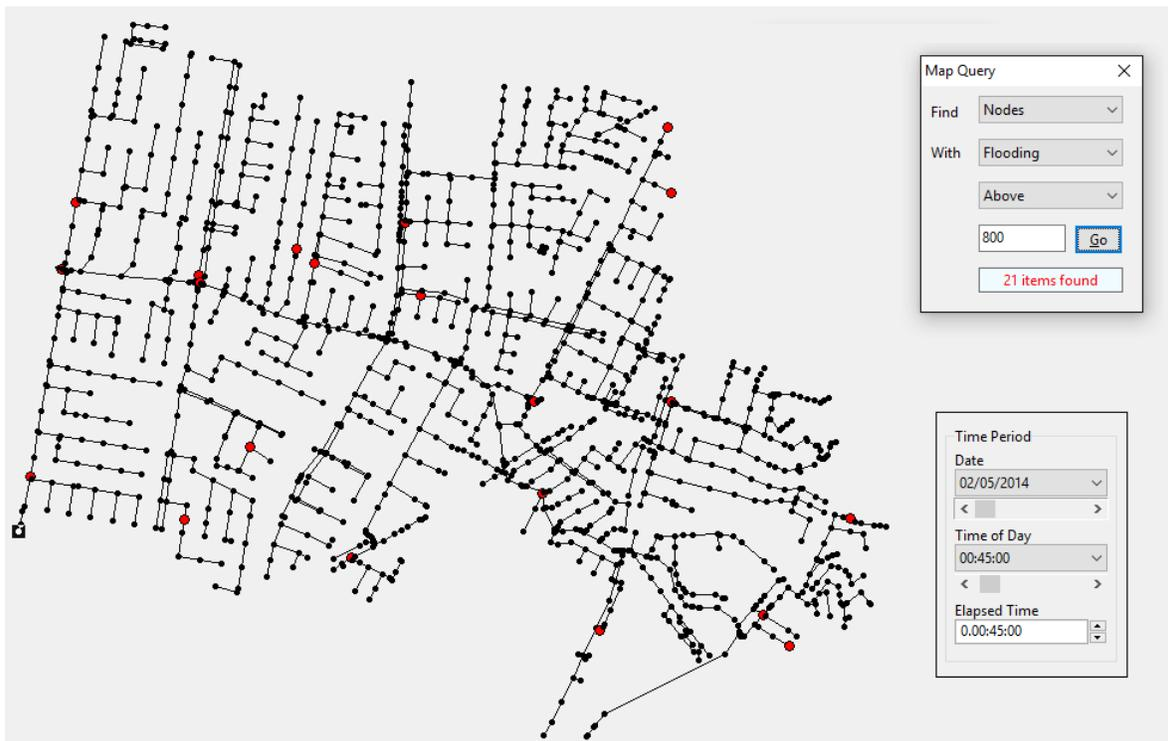
Figura 25. Nodos de la red Chicó Norte con inundaciones superiores a los 800 lps en el minuto 45.
