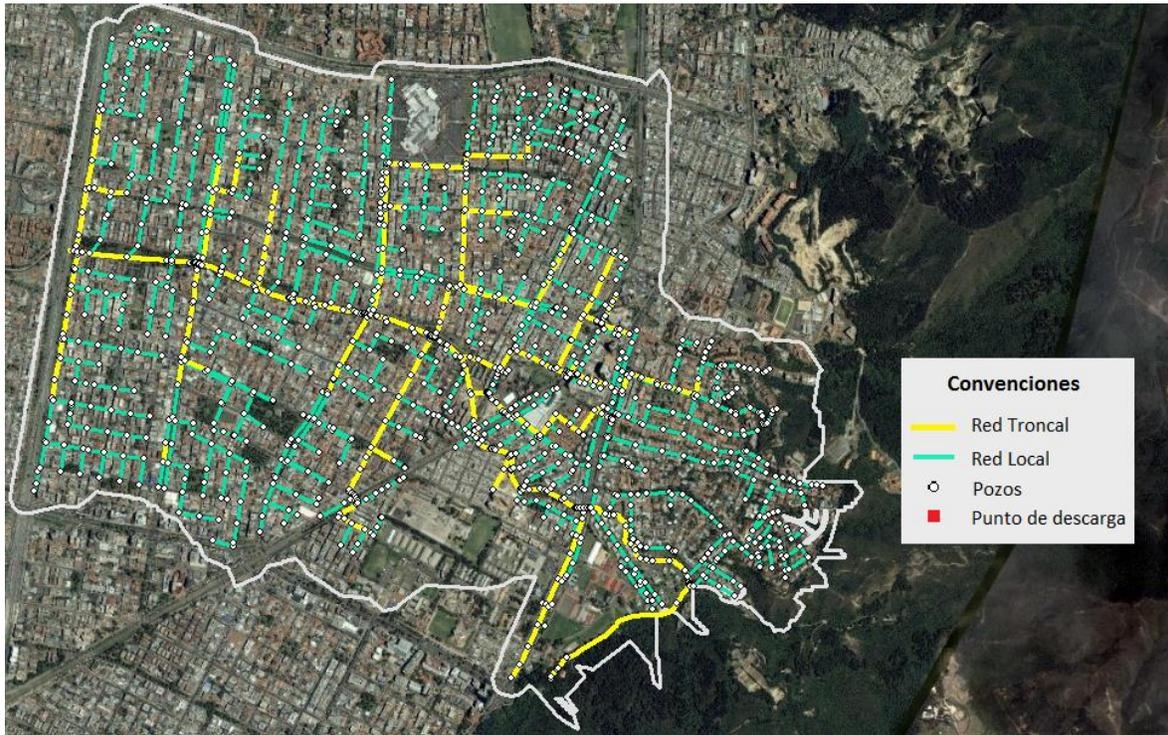
**Figura 15. Configuración hidráulica de la red de alcantarillado pluvial “Chicó Norte”.**
