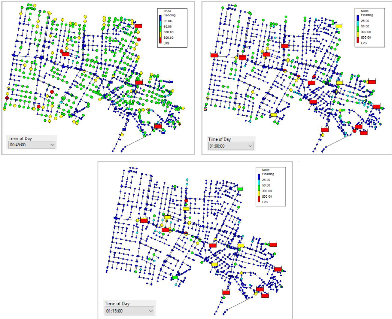
Figura 26. Ubicación de tanques y caudal de inundación en nodos y tanques del minuto 0:45 a la 1:15.
