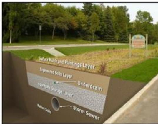
*Ilustración 5. Caracterización de Dren filtrante para el manejo de aguas lluvias.*
