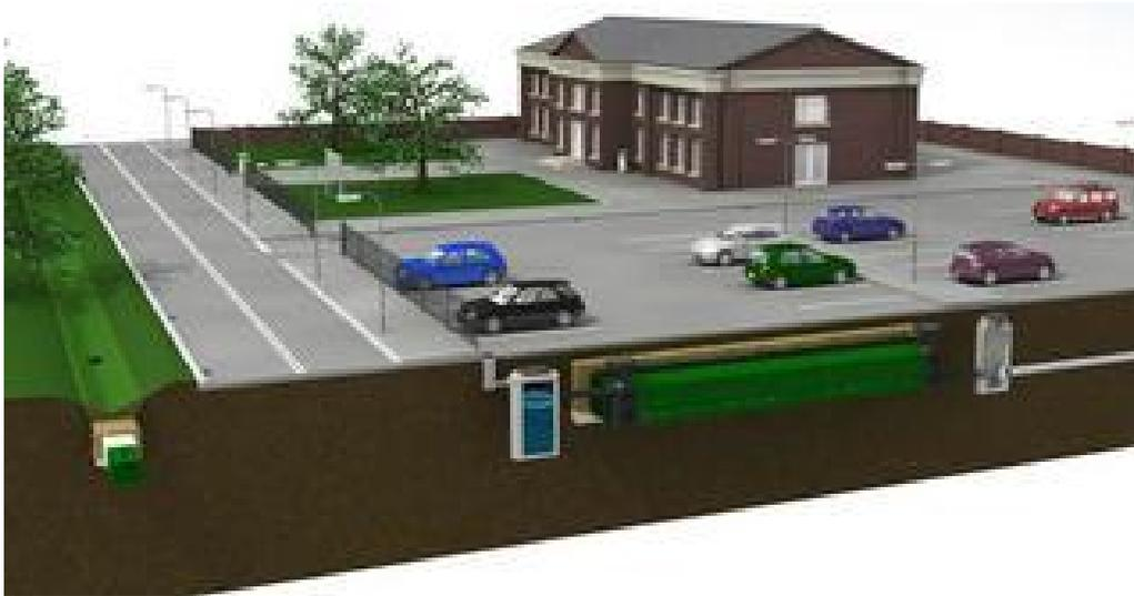
*Ilustración 2. Uso tanque de almacenamiento*
