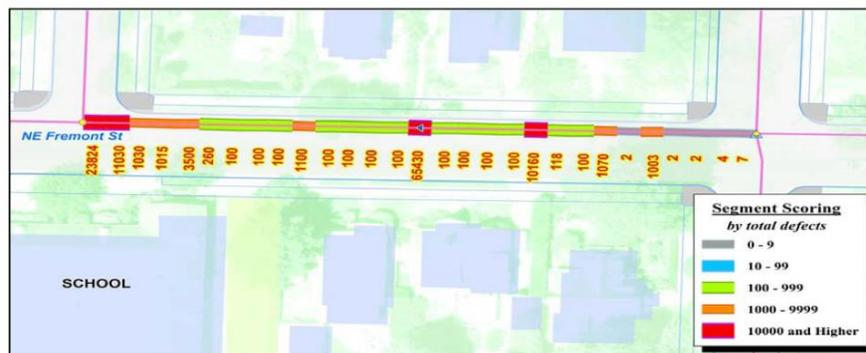
Figura 3.3-1. Análisis segmentos de tubería (Fuente: Hoffman, 2014).
