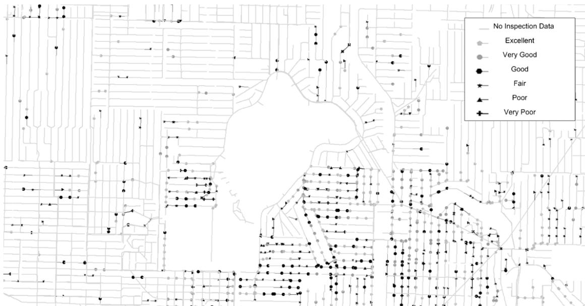
Figura 3.2-7. Clasificación de tuberías vía CCTV (PACP) (Fuente: Angkasuwansiri, 2014).
