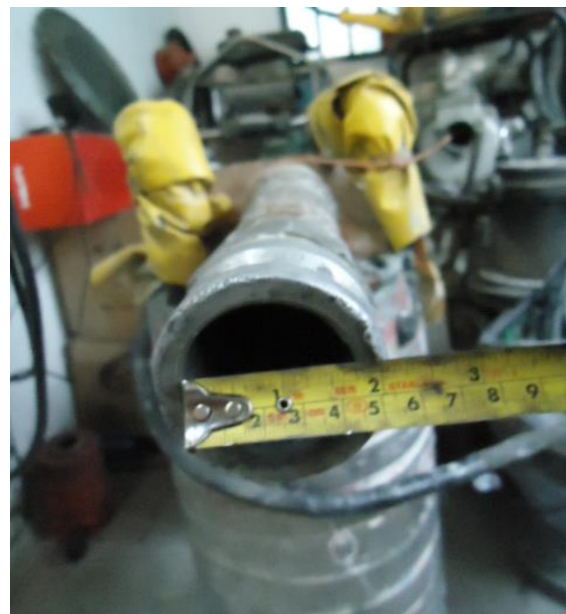
Figura 19. Estrangulamiento en la tubería de impulsión.
