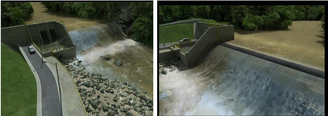
Figura 2. Captación reja de fondo presa vertedero.
