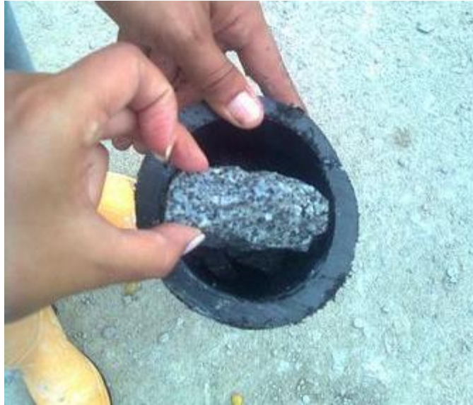
Figura 23. Roca encontrada en una tubería después de haber avanzado aproximadamente 100 m.
