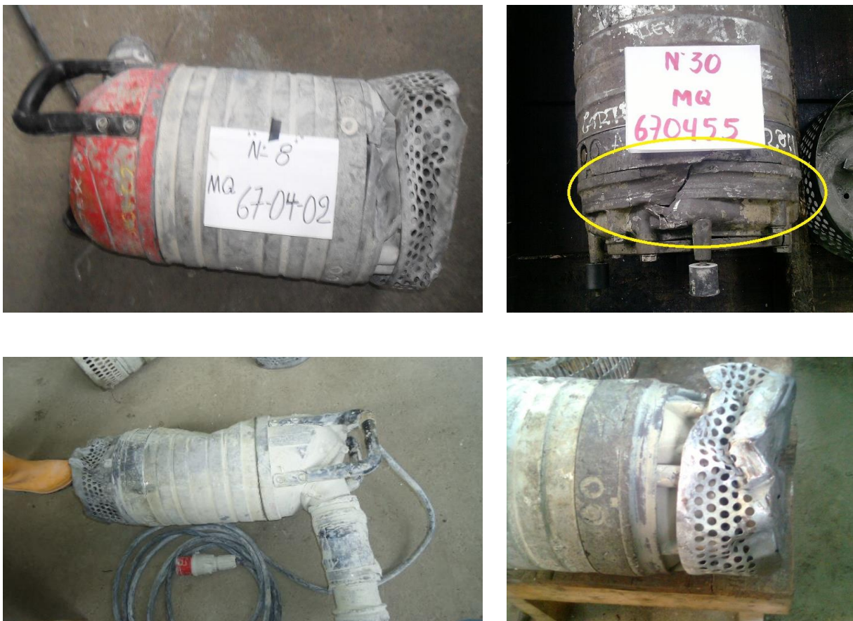
Figura 20. Golpes a la bomba del frontón del túnel.
