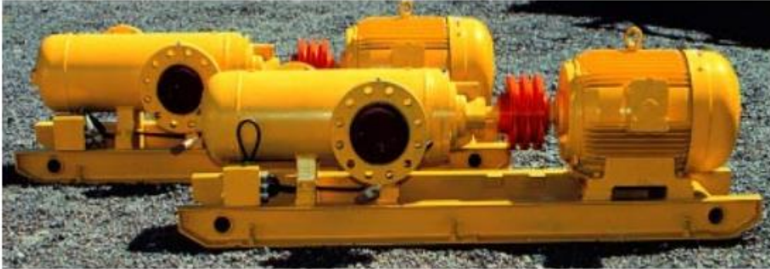
Ilustración 6-3. Bomba Inyectora MP BTG/HX HILLMAN. Adaptada de: (HILLMANN, 2013).
