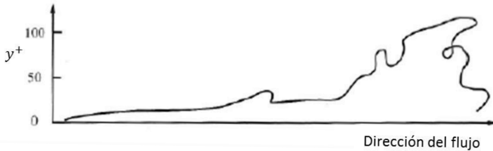
Ilustración 5-14. Movimiento de un streak hacia el centro de la tubería. Adaptada de: (Bohórquez, 2012).
