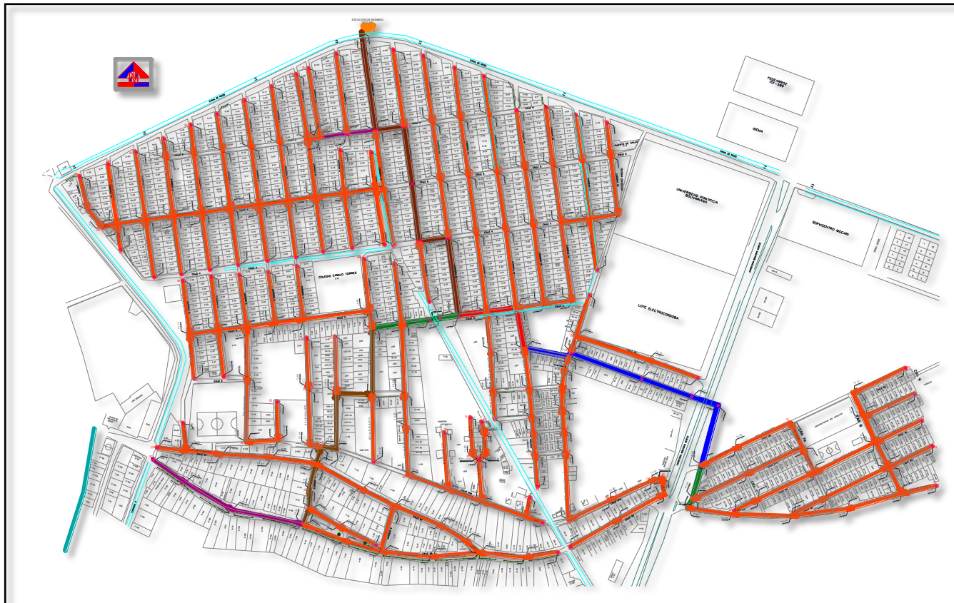
Figura 6. Planta general alcantarillado sanitario de Mocarí-Montería 31 .
