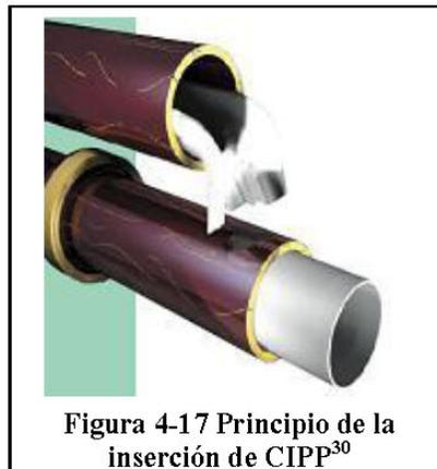
Figura 4-17 Principio de la inserción de CIPP<sup>30</sup>
