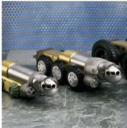
Figura 5. Cámaras montadas sobre transportadores de diferentes tamaños.<sup>5</sup>
