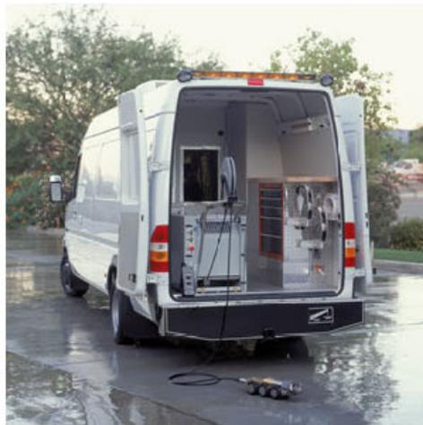
Figura 6. Van acondicionada con los equipos de centro de mando.<sup>6</sup>
