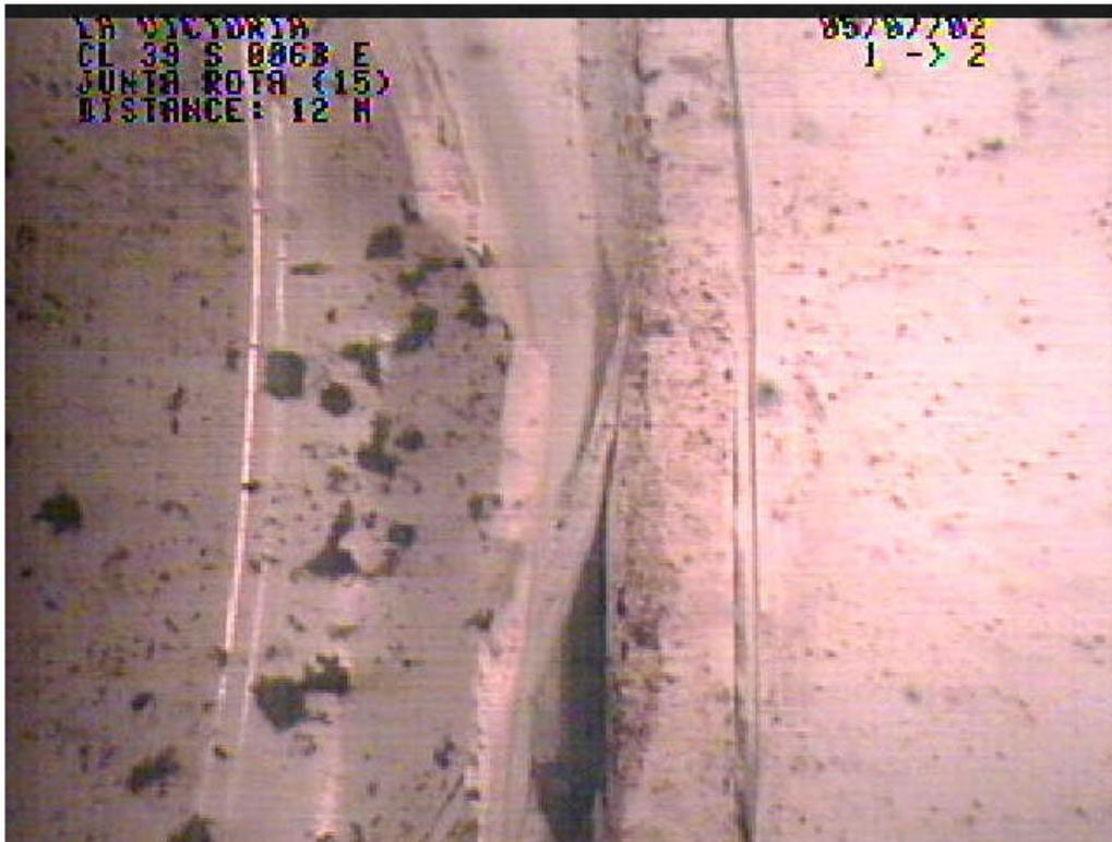
Figura 16. Junta rota en tubería de PVC.
