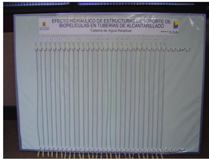
Figura 5.3. – Tablero de piezómetros
