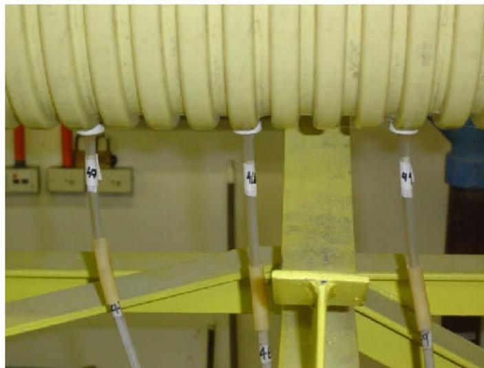
**Figura 2-6. Detalle piezómetros en el fondo de la tubería.**
