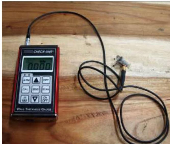
Figura 4-19 Medidor de Espesor
