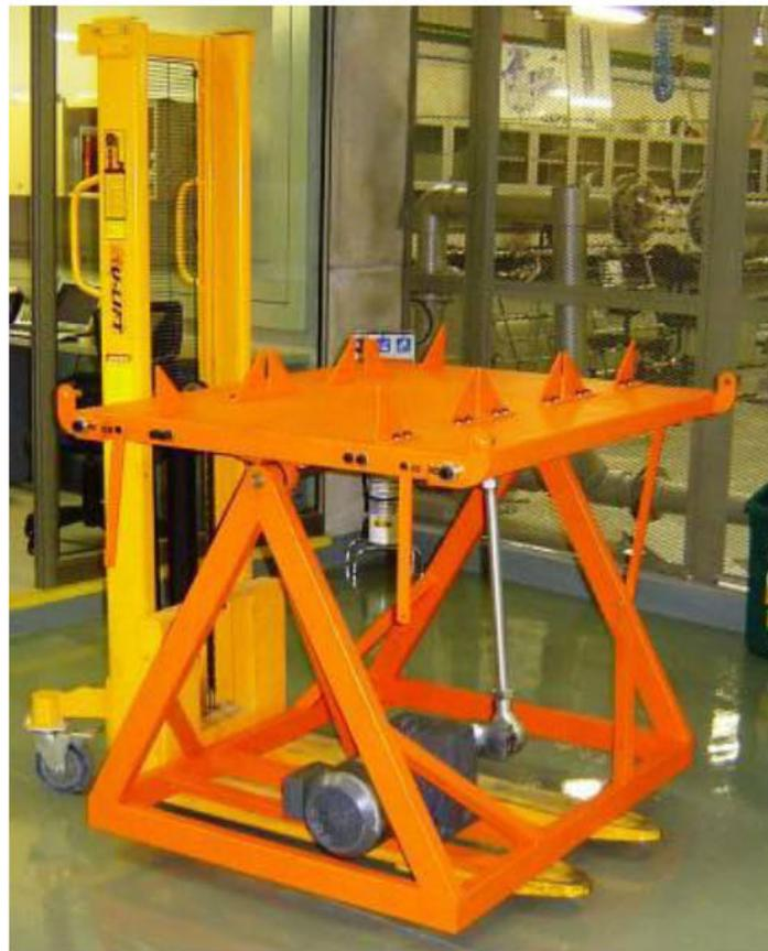
Figura 4-13 Mesa Máquina de Abrasión
