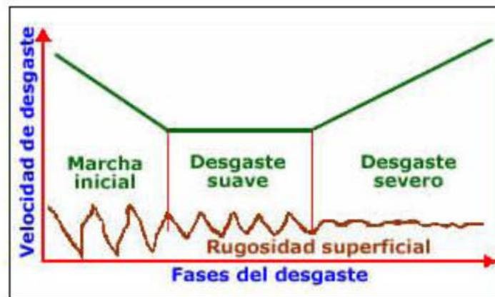
Figura 2-2 .Fases del Desgaste Versus Velocidad de Desgaste<sup>1</sup>
