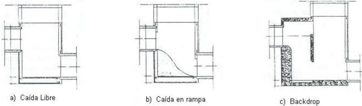
Figura 5-3 Tipos de caída típicas en alcantarillados (Almeida, 1999)
