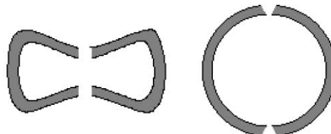
Figura 5-1 Cambio en el tamaño de los agujeros dependiendo de la presión aplicada (izq: no presurizada, der: presurizada) (Tjandraatmadja, G.F. 2002)
