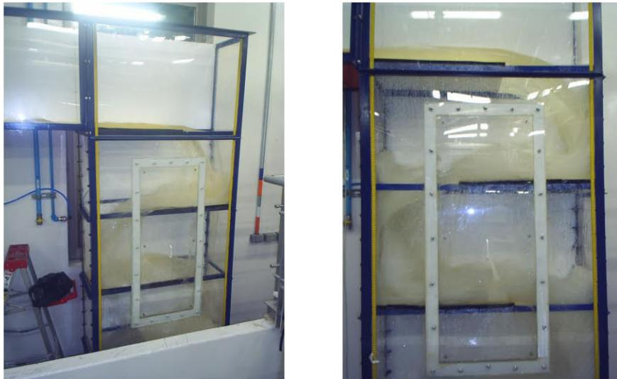
Figura 12.- Comportamiento del Modelo: (a) Caudales Bajos, (b) Caudales Altos.
