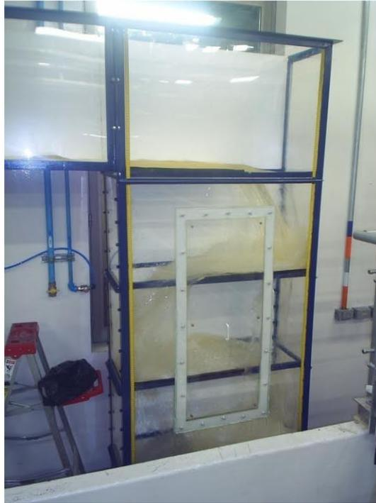
**Figura 8.-** Cámara de Caída con Bandejas.
