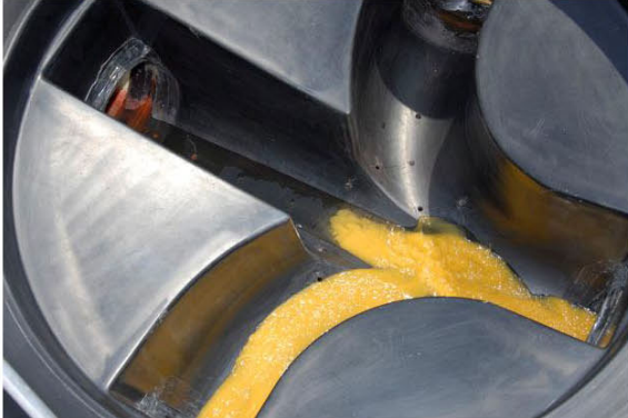
Figura 2. Configuración de entrada 90°.
