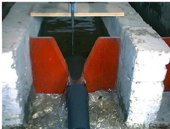
Figura 5.5: Vertedero triangular de 60° condicionado con su limnómetro.
