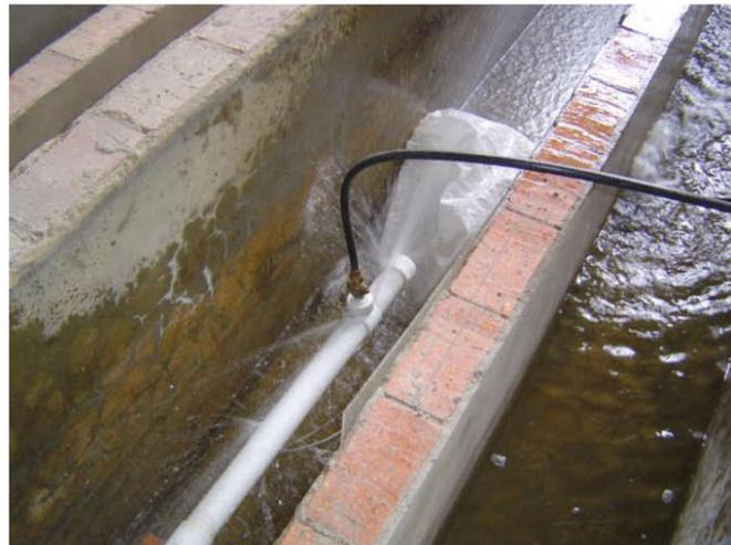
Figura 7.16: Fuga a través de un collar de derivación sin empaque desplazado un 60 % del diámetro del orificio de la acometida de forma longitudinal para la tubería de 4".
