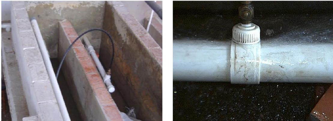
Figura 7.2: Montaje de las fallas evaluadas en conexiones domiciliarias.
