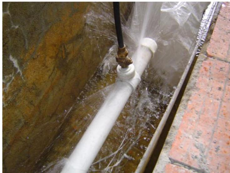
Figura 7.22: Fuga a través de un collar de derivación con empaque desplazado un 80 % del diámetro del orificio de la acometida de forma transversal para la tubería de 4".
