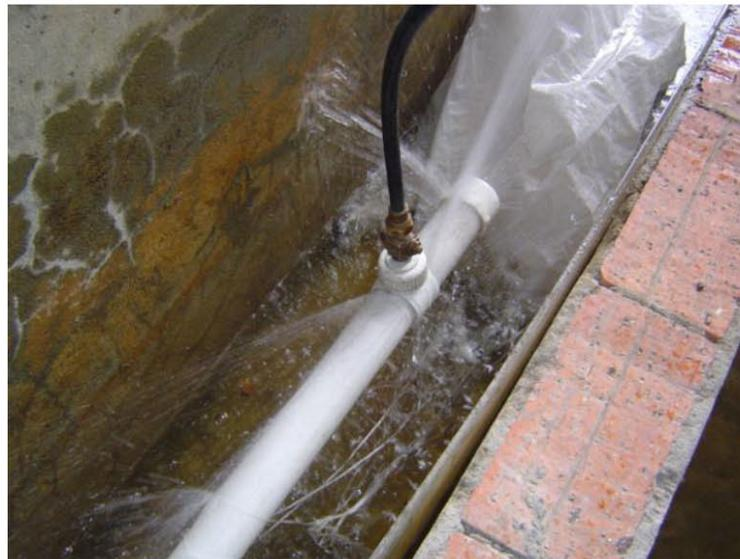
**Figura 7.25: Fuga a través de un collar de derivación sin empaque desplazado un 36 % del diámetro del orificio de la acometida de forma transversal para la tubería de 2”.**
