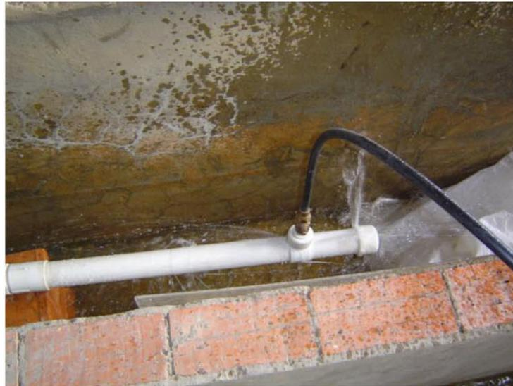
**Figura 7.13:** Fuga a través de un collar de derivación sin empaque desplazado un 26 % del diámetro del orificio de la acometida de forma longitudinal para la tubería de 3”.
