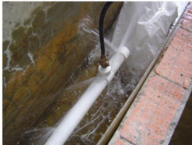
Figura 7.31: Fuga a través de un collar de derivación sin empaque desplazado un 100 % del diámetro del orificio de la acometida de forma transversal para la tubería de 4".
