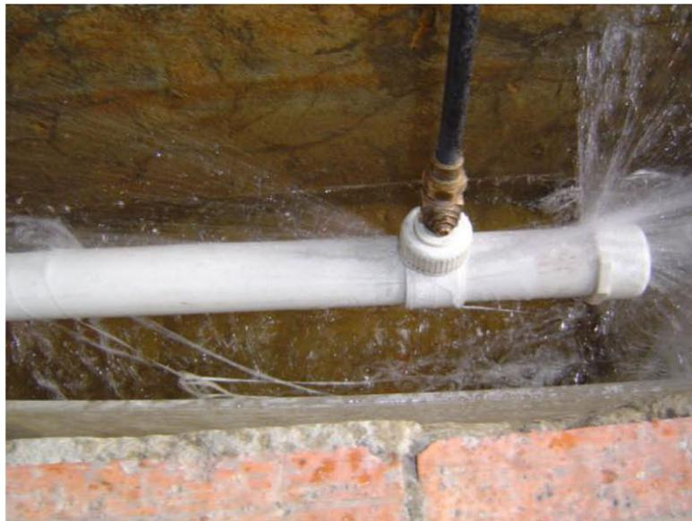
Figura 7.28: Fuga a través de un collar de derivación sin empaque desplazado un 52 % del diámetro del orificio de la acometida de forma transversal para la tubería de 3".
