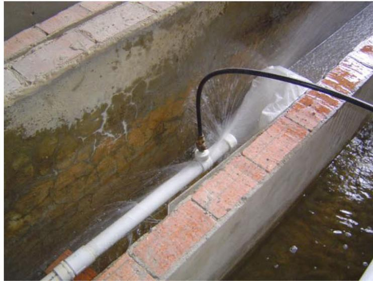
**Figura 7.19: Fuga a través de un collar de derivación con empaque desplazado un 100 % del diámetro del orificio de la acometida de forma transversal para la tubería de 2”.**
