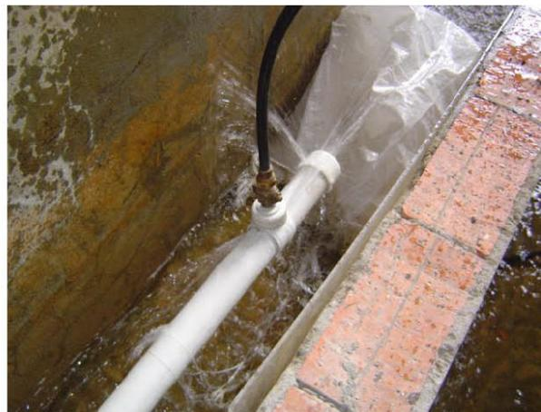
Figura 7.4: Fuga a través de un collar de derivación con empaque desplazado un 75 % del diámetro del orificio de la acometida de forma longitudinal para la tubería de 2".
