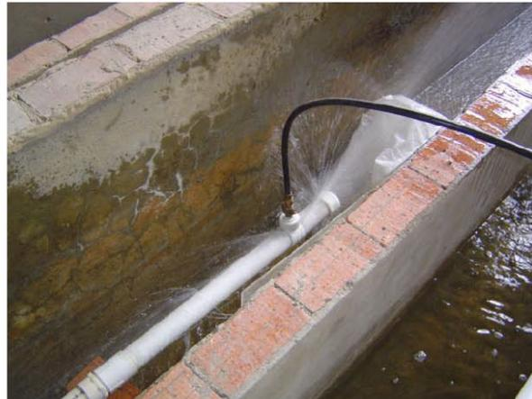
**Figura 7.7:** Fuga a través de un collar de derivación con empaque desplazado un 44 % del diámetro del orificio de la acometida de forma longitudinal para la tubería de 4”.
