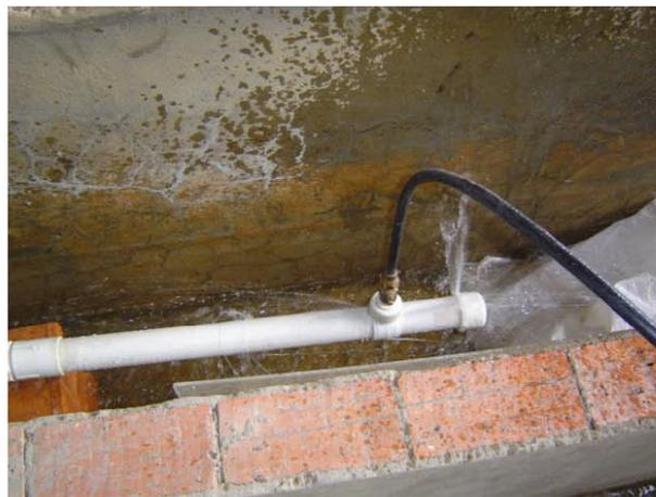
Figura 7.10: Fuga a través de un collar de derivación sin empaque desplazado un 52 % del diámetro del orificio de la acometida de forma longitudinal para la tubería de 2".
