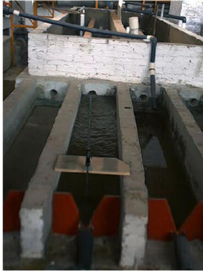
Figura 5.3: Canal No. 2 para pruebas, condicionado con los sistemas de quietamiento.
