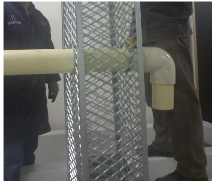
Figura 7. Estructuras disipadoras de energía.
