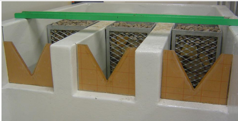
Figura 8. Instalación de Vertederos.
