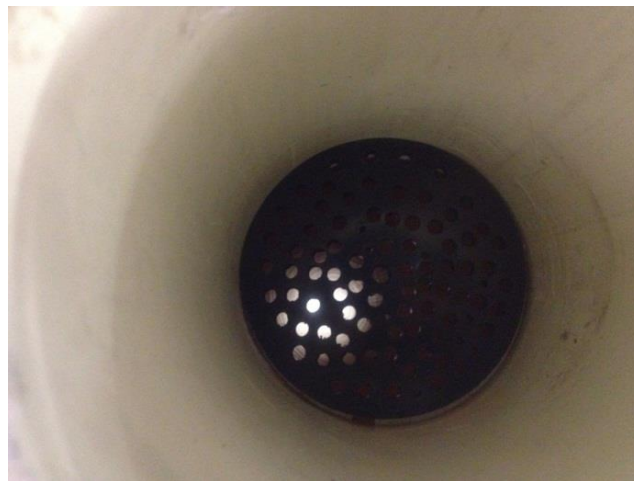
Figura 80. Instalación de la primera rejilla uniformadora de flujo.
