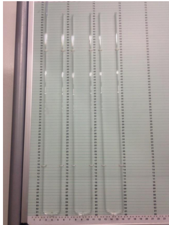
Figura 102. Instalación de los manómetros.
