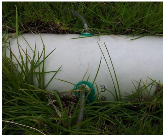
Figura 24 Mangueras de manómetros y sensor de presión diferencial
