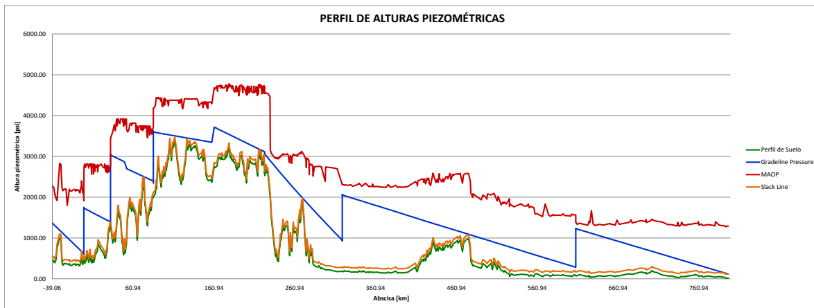
Gráfica 6-4. Perfil de alturas piezométricas primeros 200 km del oleoducto con crudo Cusiana.
