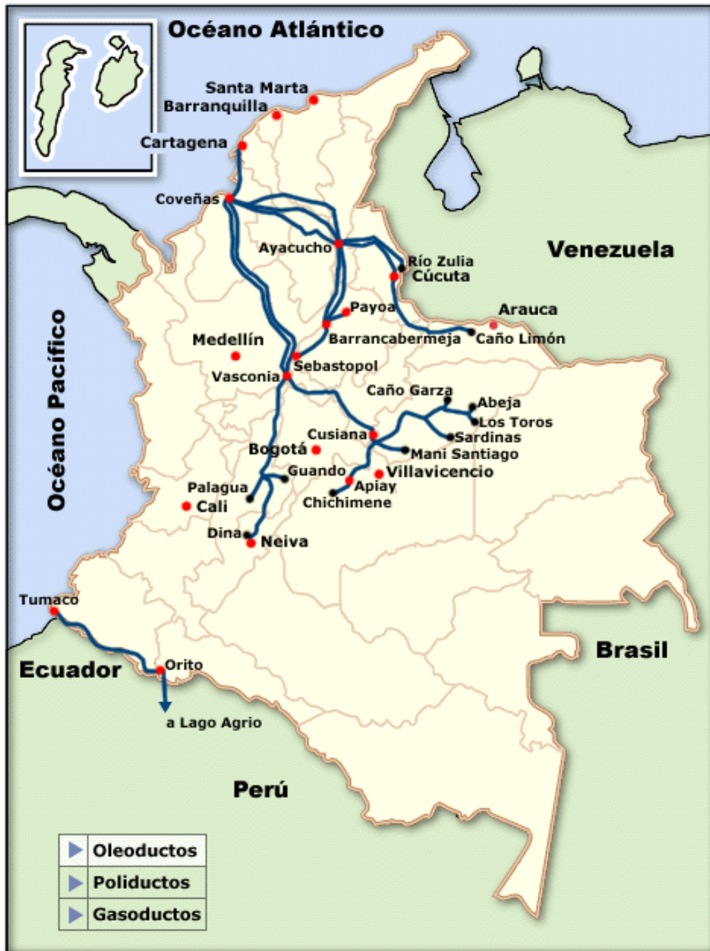
Figura 2-1. Infraestructura Petrolera de Colombia - Oleoductos. Fuente: (Ecopetrol, Redes de transporte, 2012).
