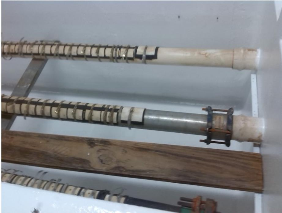
Figura 7 “ "Montaje biopelículas tuberías de materiales diferentes y diámetro de 4" ”.
