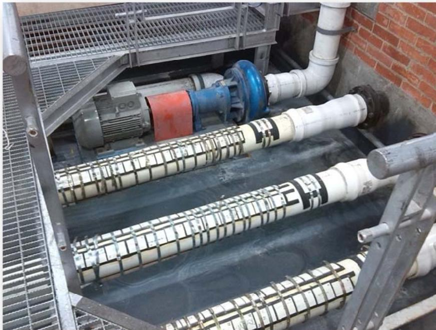
**Figura 6** “Montaje de biopelículas de medición de velocidades con tuberías de PVC de 6” ”.
