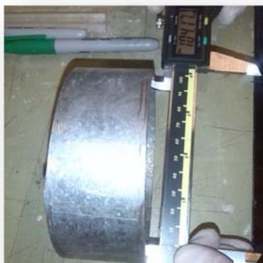
Figura 32 "Medición del diámetro interno de las tuberías".
