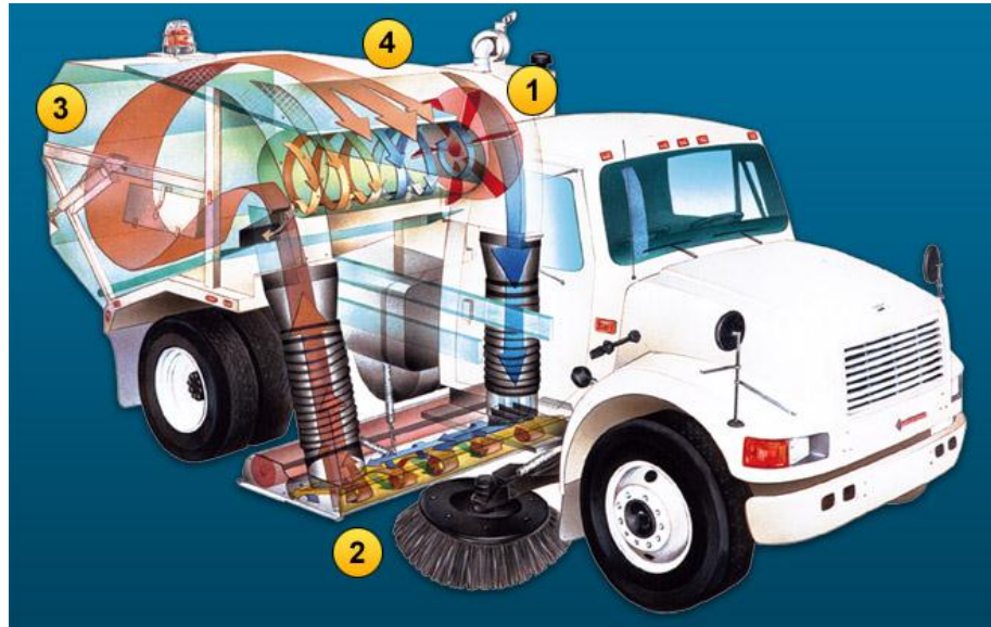
Ilustración 36 Barredora de Aire Regenerativo. Tomada de TYMCO Inc (2014).
