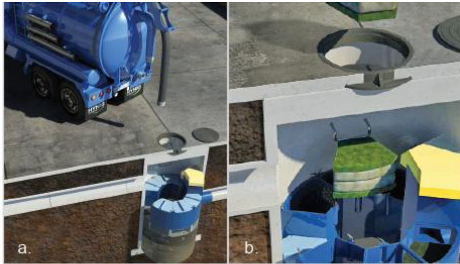
Ilustración 42 Mantenimiento Filtro Up-Flow. Tomado de Hydro International (2008).
