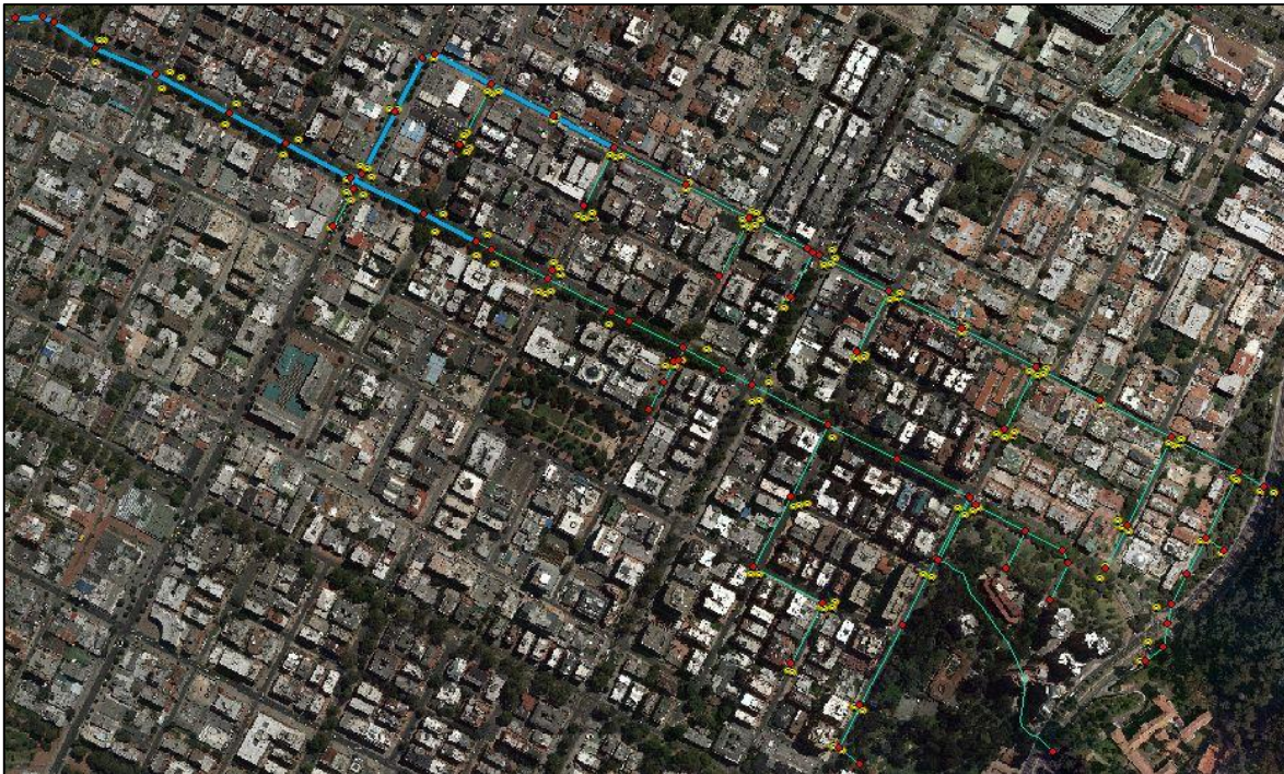
Figura 5.19 Orto foto del caso de estudio Pequeño Chicó con localización de sumideros (Nudos amarillos) y pozos de la red (Nudos rojos).
