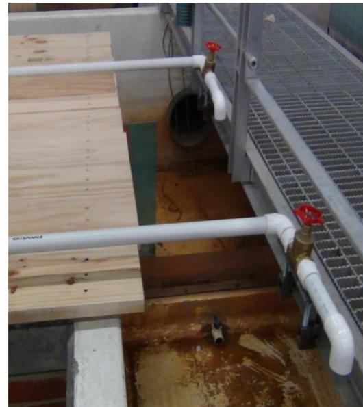
**Figura 47. Válvulas de entrada y salida para controlar caudal.**
