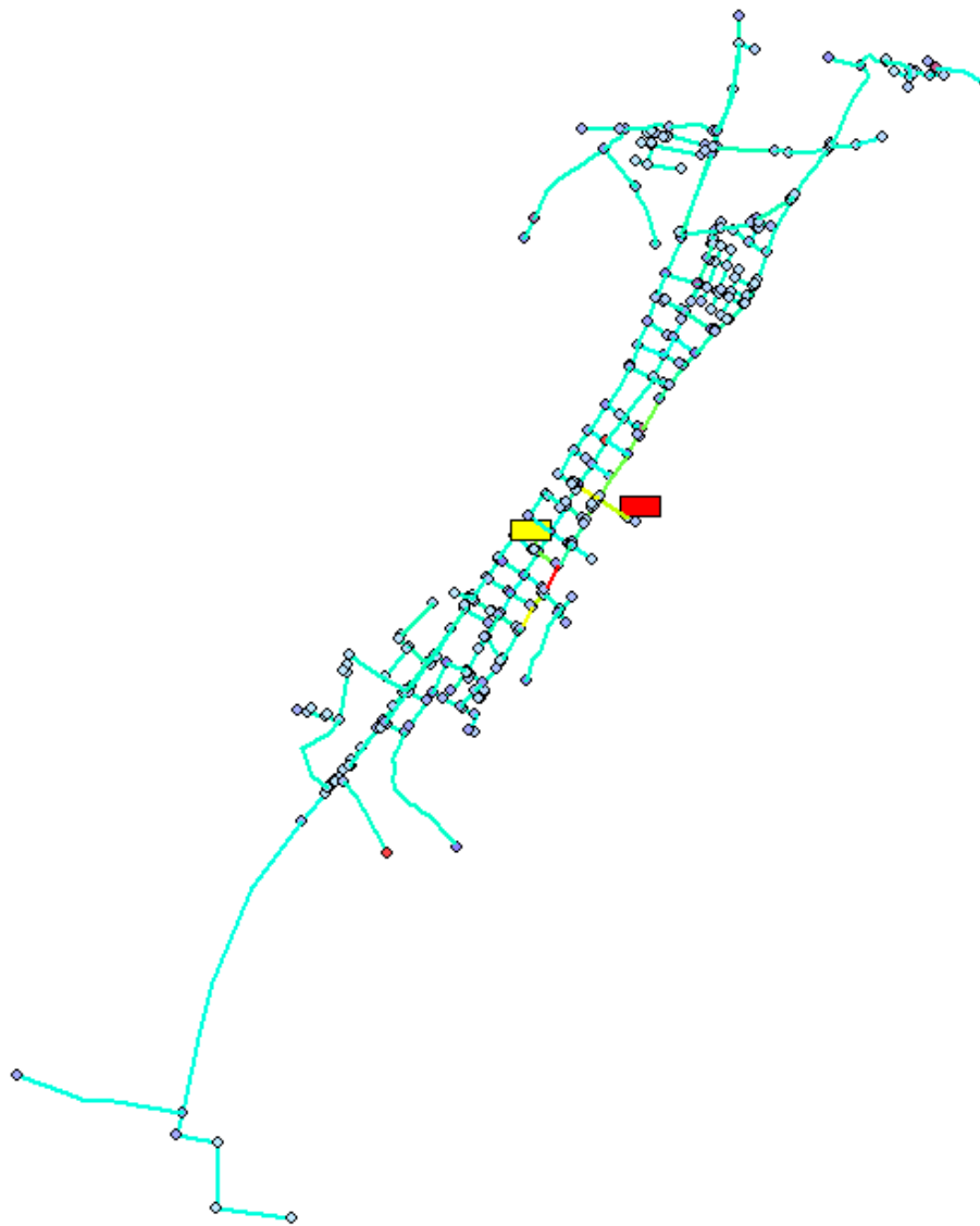
Figura 6-18. Red Andalucía Alta con el nuevo embalse y diámetros de la red matriz modificados.
