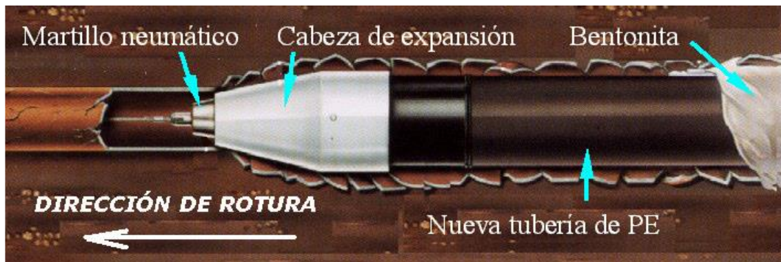
Figura 7. – Proceso de rotura de la tubería instalada. .( www.sinzatec.es).
