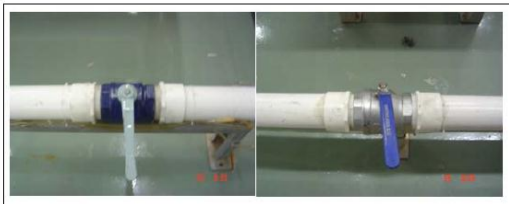
Figura 2-3. Válvulas para direccionar el flujo (Usadas para probar la Tee en flujo recto y flujo lateral)
