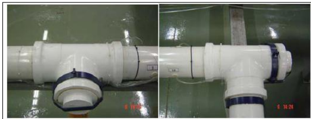
Figura 2-4. Tapones usados en el modelo 2 para probar la Tee en flujo lateral y flujo recto
