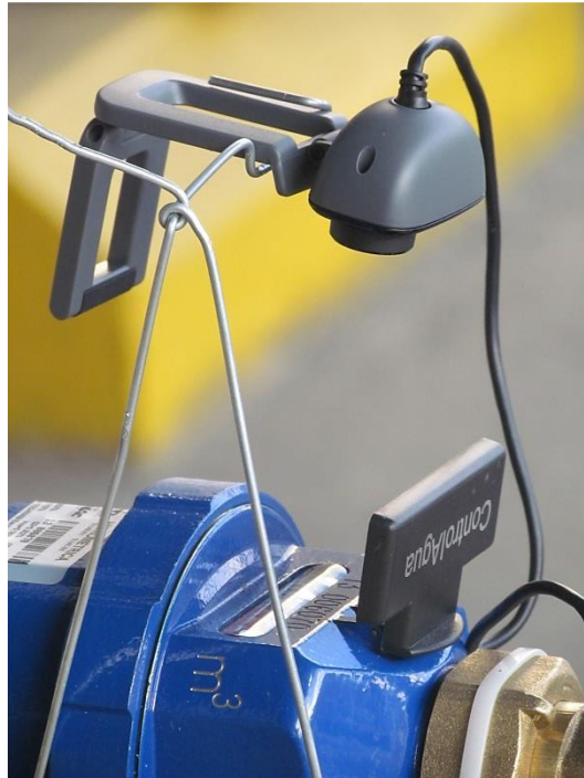
Fotografía 11. Posicionamiento de la cámara web sobre el medidor de volumen
