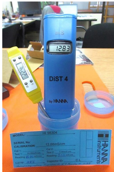
Fotografía 10. Verificación de la lectura de la conductividad respecto a la temperatura del agua según certificación del fabricante
