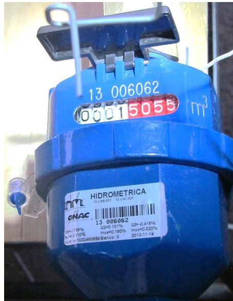
Fotografía 2. Medidor volumétrico utilizado para el experimento
