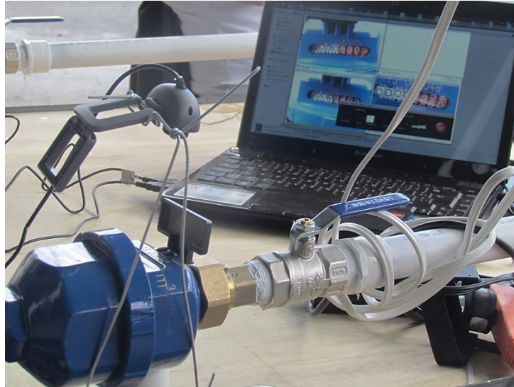
Fotografía 5. Montaje de la cámara web y ajuste de la imagen en el software de video
