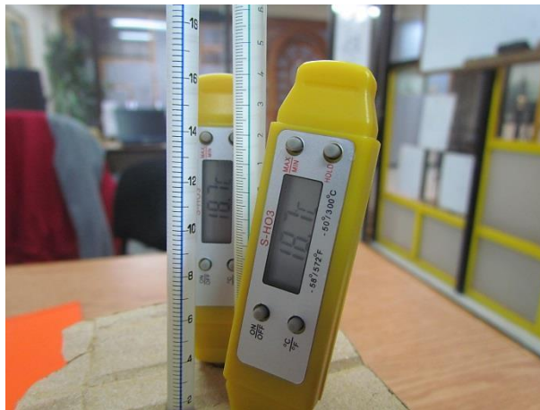
Fotografía 8. Comparación temperatura en el patrón con los equipos termo-resistivos utilizados
