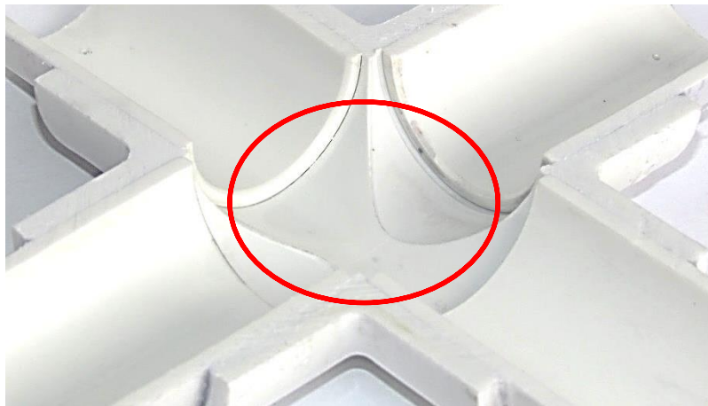
Fotografía 15. Imperfecciones derivadas del proceso de fabricación (cruz PVC soldada)
