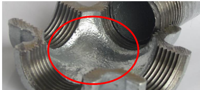
Fotografía 17. Imperfecciones derivadas del proceso de fabricación (cruz hierro galvanizado roscada)
