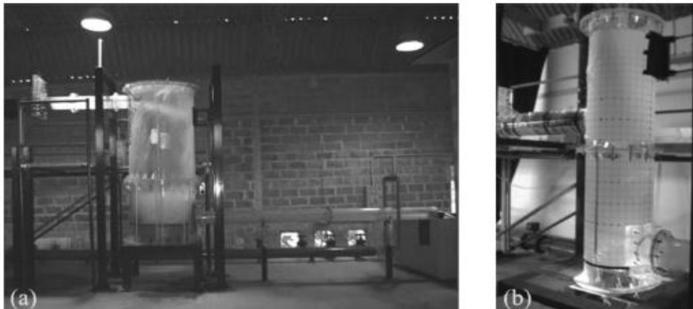
Foto 6. Montaje de cámara circular de caída (a) vista lateral (b) cámara del modelo.
