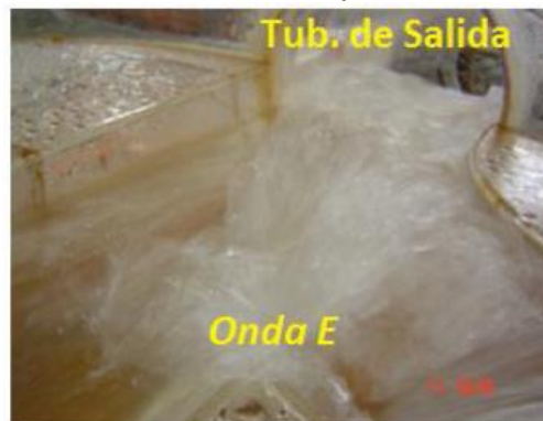
Foto 16. Desarrollo de la Onda E para la unión de los flujos.
