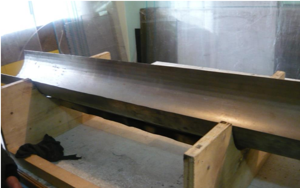
Foto 19. Molde utilizado para la fabricación de las tuberías.
