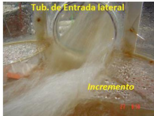
Foto 12. Incremento de la lámina de agua en la pared externa del canal de conducción lateral.
