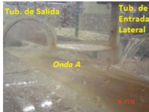
Foto 14. Desarrollo de la Onda A para la unión de los flujos.
