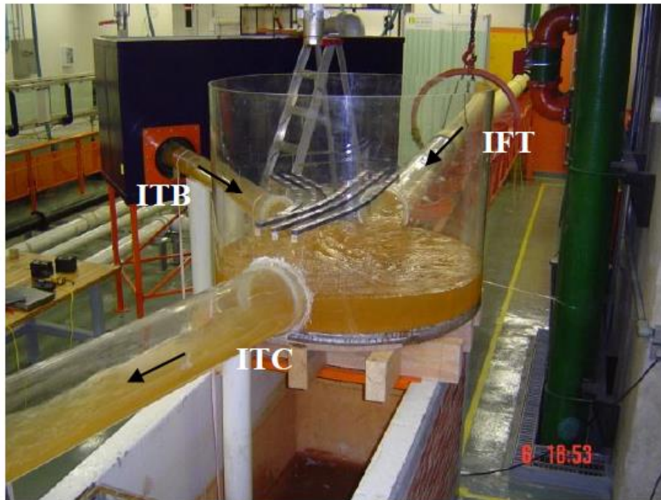
Foto 4. Modelo físico de la estructura de conexión e interceptores.
