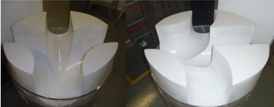
Foto 27. Cañuela en acrílico (izq) vista aguas abajo, (der) vista lateral.
