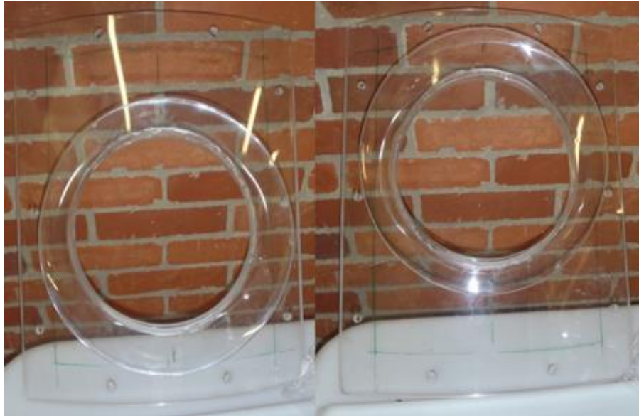
Foto 30. Tapa de acople (izq) altura de caída=10cm; (der) altura de caída=16cm.
