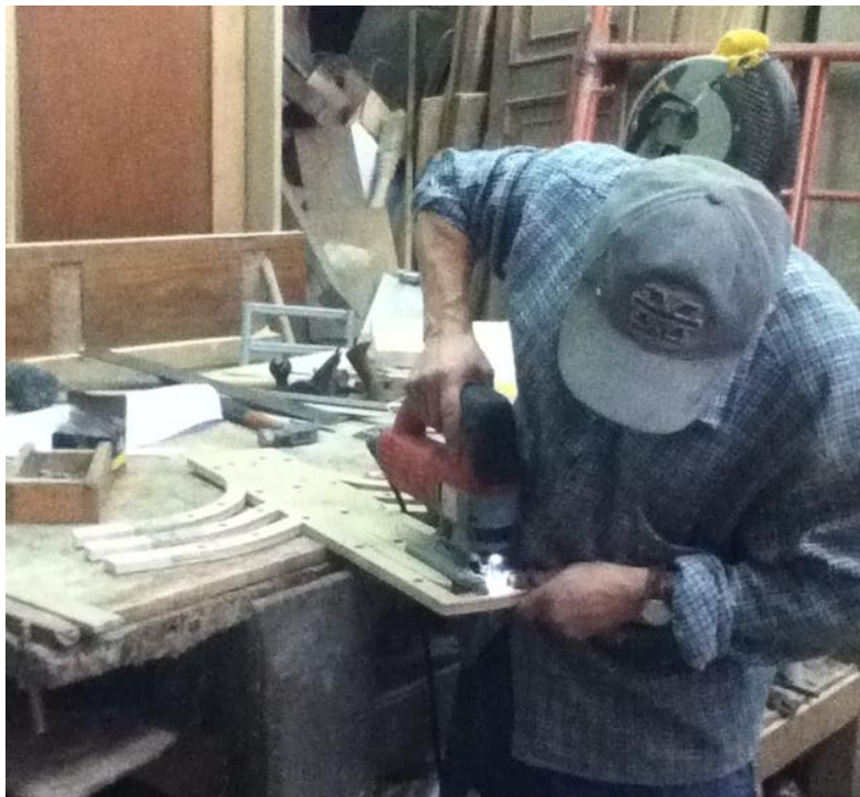
Foto 24. Elaboración del soporte para el sensor de nivel en la cámara 2.
