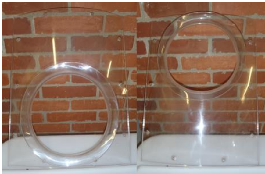
Foto 31. Tapa de acople (izq) altura de caída=4cm; (der) altura de caída=22cm.
