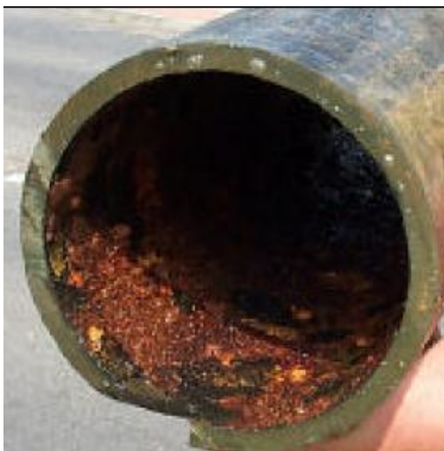
Figura 9. Depósitos de óxidos formados en una conducción de agua potable de hierro (Wricke, et al., 2007).
