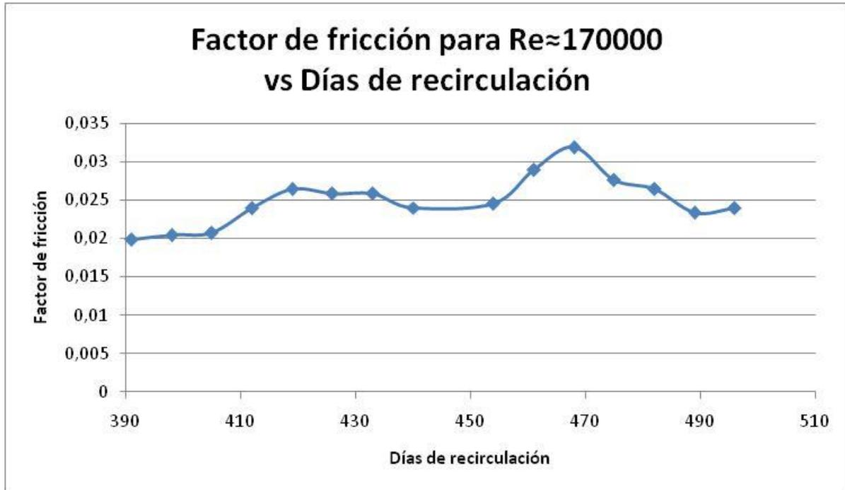
Ilustración 8 Factor de fricción para Reynolds de 170000 para tubería 2.
