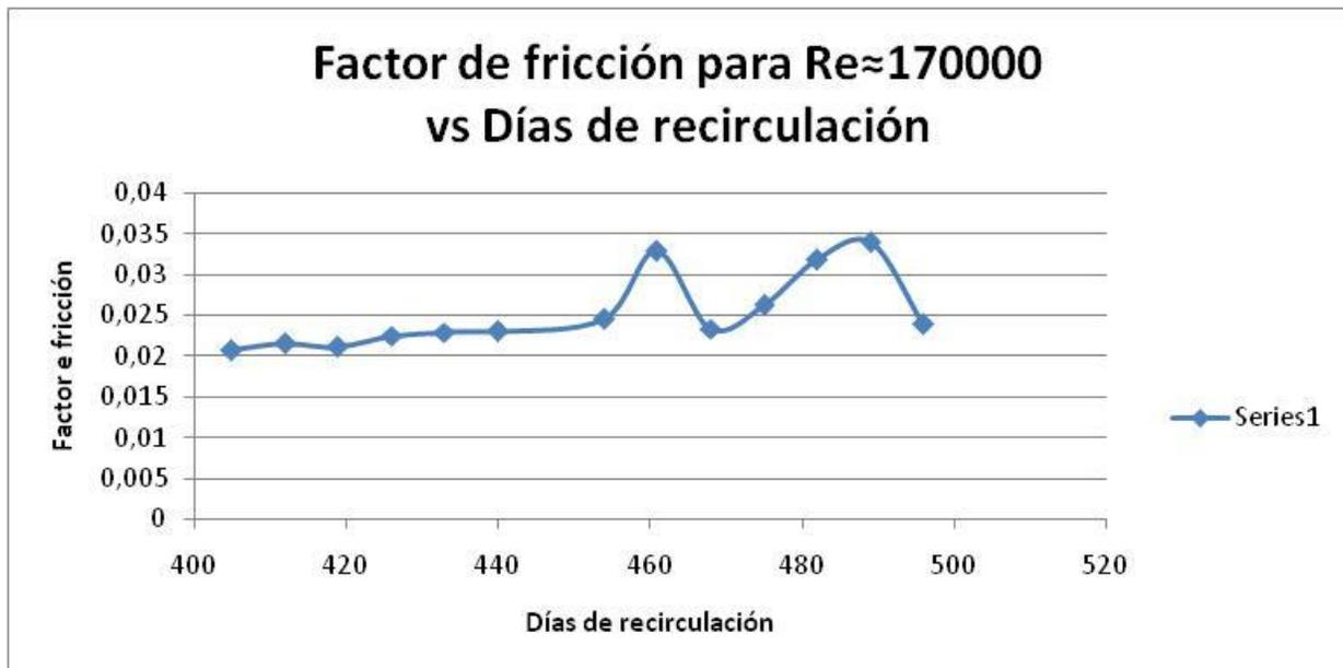
**Ilustración 9 Factor de fricción para Reynolds de 170000 para tubería 3.**
