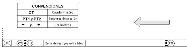
**Figura 2.-** Distribución de los piezómetros en la tubería.
