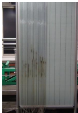
Figura 14. Tablero piezométrico para la toma de pérdidas por fricción.
