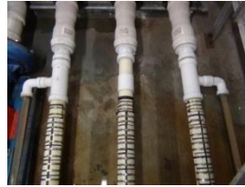
Figura 11. Testigos de centro y tubos de vidrio en el montaje.
