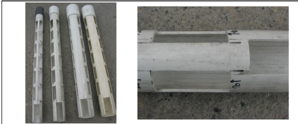
Figura 7-7 Soportes de los testigos para las cuatro tuberías
