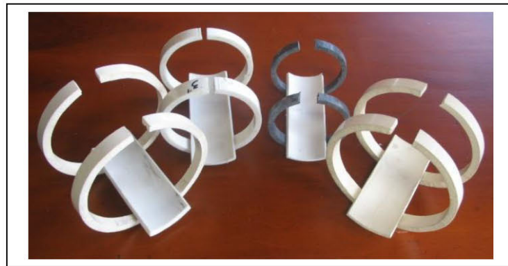
Figura 7-9 Testigos del borde para evaluar crecimiento progresivo de biopelícula
