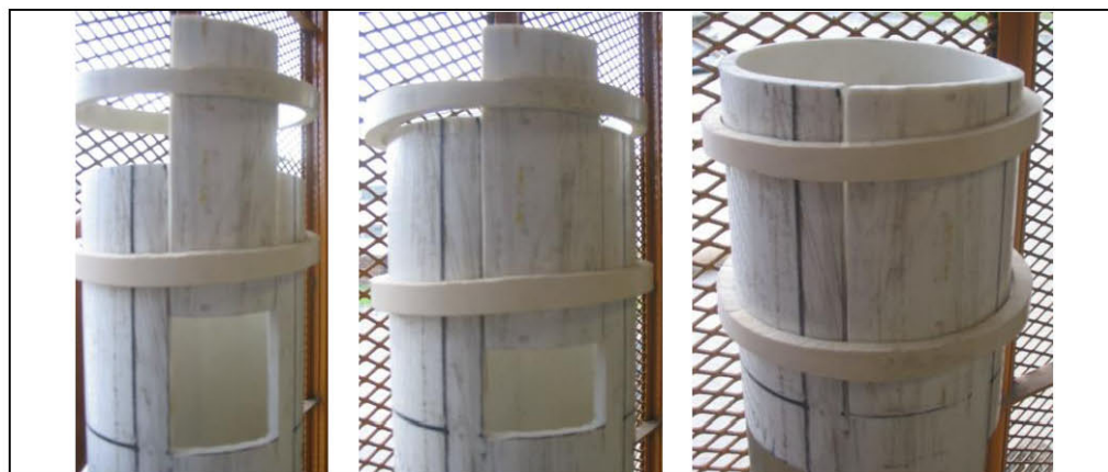
Figura 7-10 Proceso de colocación del testigo del borde. En este caso para PVC de 4"
