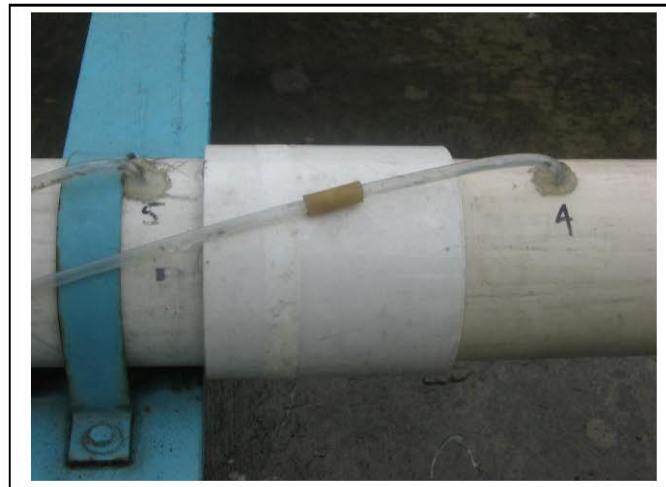
Figura 7-5 Instrumentación de la unión de 4"
