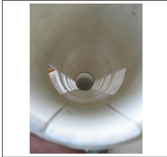
Figura 7-11 Vista interna del muestreador de PVC de 4" con el testigo del borde colocado
