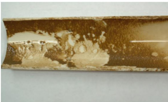
Figura 5-5. Fotografías del estado de la biopelícula en uno de los dispositivos de medición, luego de 205 días de recirculación en la Fase III.
