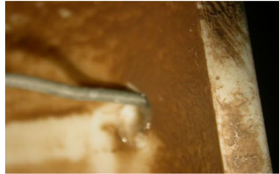
Figura 5-3. Izquierda: Fotografía de la microestructura de la biopelícula formada en los dispositivos de muestreo. Derecha: Aspecto de la biopelícula en el dispositivo, después de 155 días de recirculación en la Fase II
