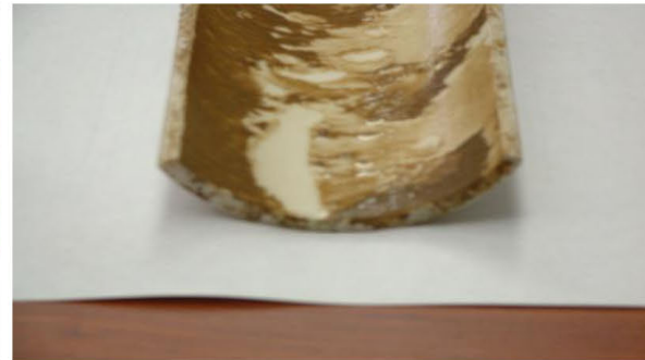
Figura 5-5. Fotografías del estado de la biopelícula en uno de los dispositivos de medición, luego de 205 días de recirculación en la Fase III.
