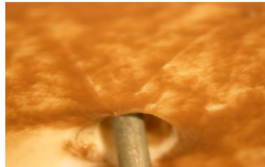
Figura 5-4. Izquierda: Fotografía de la microestructura de la biopelícula formada en los dispositivos de muestreo. Derecha: Aspecto de la biopelícula en el dispositivo, después de 184 días de recirculación en la Fase III
